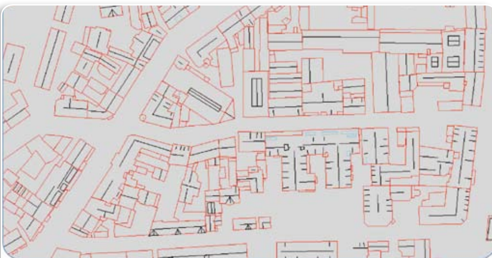
Modèle Numérique d'Élévation vectoriel avec les emprises des bâtiments et les faitages des toitures.
