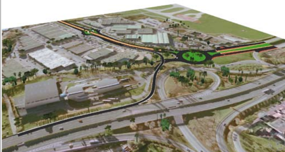
Insertion d'une voie de « bus à haut niveau de service » (BHNS), avec création d'une nouvelle bretelle d'accès à l'autoroute A8 (secteur Cannes la Bocca).
