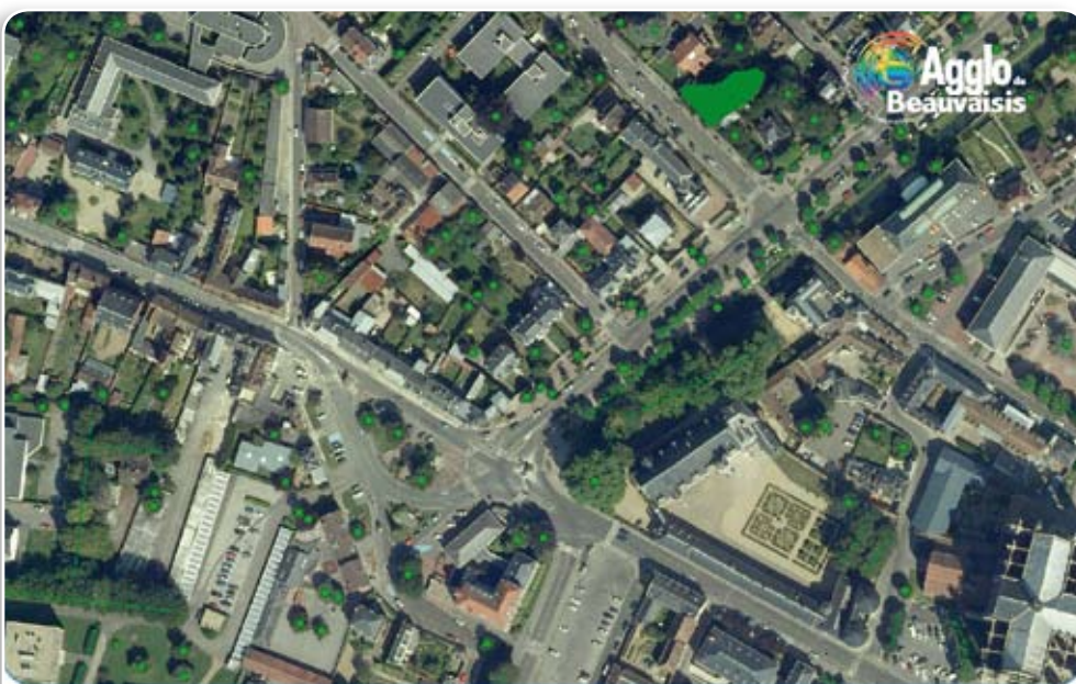
Base de Données Végétation : superposition des objets vectoriels végétation (zone boisée, alignement d'arbres et arbre isolé) à l'orthophotoplan ayant servi de support pour la photo-interprétation.
