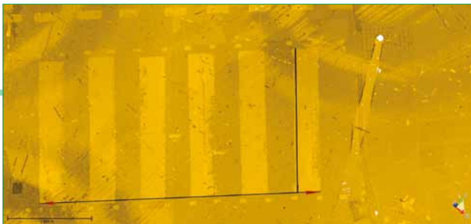
Nuage de points obtenu par scan laser sur Abbey Road — 27/08/2016 © Servicad.
